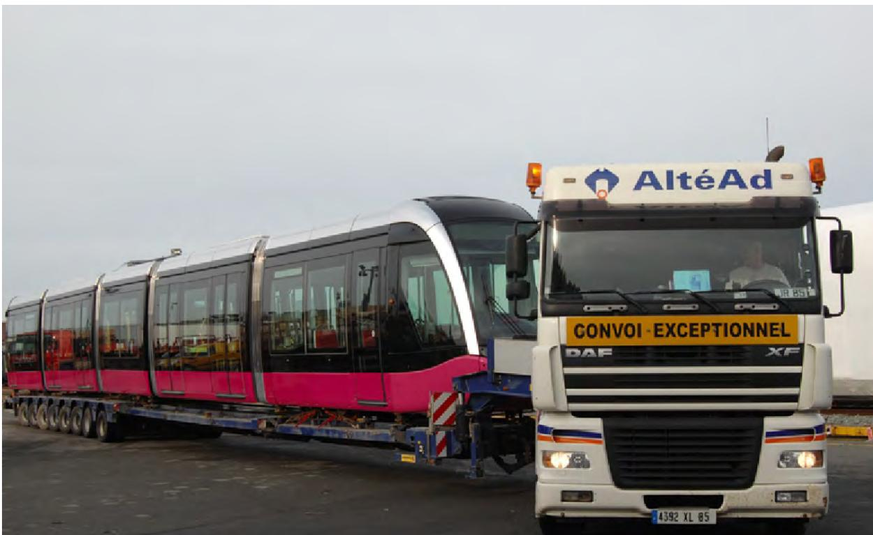
Figure 3 : Photo d'un camion de livraison d'une rame de tramway
